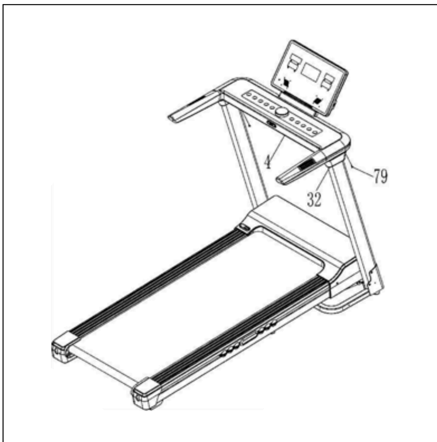
Рисунок 4 – Установка декоративных заглушек под консолью
