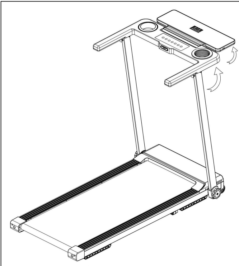
Рисунок 4 — Установка и фиксация консоли
