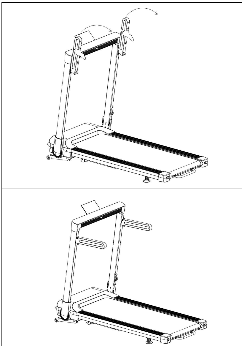
Рисунок 15 – Схема опускания поручней
